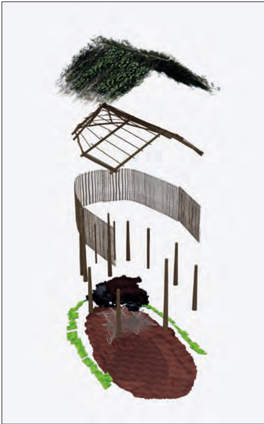
Figur 2: Sprängskiss av en möjlig tolkning av konstruktionen av hus 25 och förslag till tolkning av husets konstruktion. 3D-visualisering; Patrik Hallberg.
